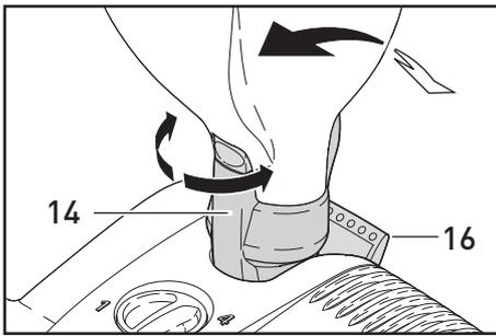
Zum Arbeiten das Rastpedal (16) betätigen und das Gerät nach hinten kippen. Die Bürste läuft jetzt an. Ein Arbeiten ohne Betätigen des Rastpedals führt auf Dauer zur Beschädigung des Gerätes.
