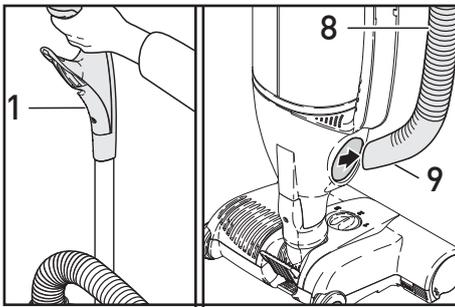
**⚠** Zur Benutzung des Schlauchs (8) mit Schlauchdüse (9) das Gerät immer in die aufrechte Position stellen!
